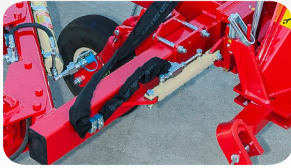
Déport hydraulique du 1er corps
