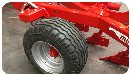
Roue arrière pour le contrôle et le transport. Très facile à utiliser, il suffit de changer la position d'un boulon. Il n'est pas nécessaire de bloquer les arrêts ou de libérer les amortisseurs.
