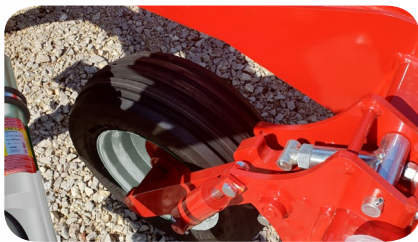
Roue de terrage avant. Disponible en 6.00*9", 200/60
