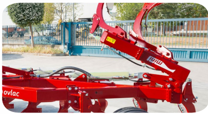
Corps supplémentaires repliables hydrauliquement pour réduire le poids et la longueur lors du transport (Mini-BF et HF uniquement)
