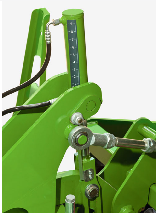
✔ Hydraulische Tiefenverstellung KX/KG
