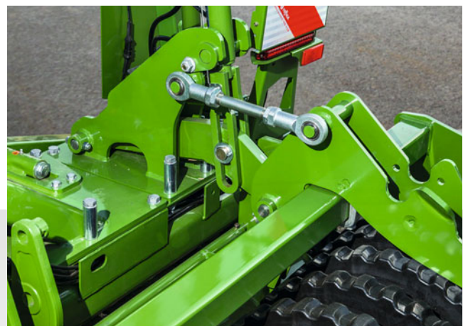
✔ Parallelführung der Walze
