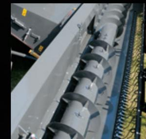
Beim FreeFlow-Schneidwerk sorgt die Einzugschnecke mit beweglichen Fingern auf voller Breite für einen kontinuierlichen Gutfluss.
