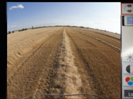
◀ Im unteren Bereich des Terminals können bis zu zwei Kamerabilder angezeigt werden. Der Fahrer kann dabei anwählen, ob die Kameraansicht immer angezeigt wird oder beispielsweise nur beim Rückwärtsfahren. Das Kamerabild kann per Knopfdruck einfach auf den kompletten Bildschirm vergrößert werden.
