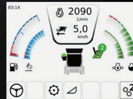
◀ Der Bereich „Allgemeine Informationen“ wird immer in der linken oberen Ecke des Bildschirms angezeigt. Er zeigt Motordrehzahl und Fahrgeschwindigkeit an. Daneben befinden sich die Anzeigen für Kraftstoff, AdBlue, Öl- und Motortemperatur. Die Grafik zeigt zudem den aktuellen Status für den Korntank und die Entleerungsschnecke.
