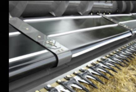
Für optimale Sicht und Leistung ist das Messer ganze 1,14 m von der Einzugschnecke entfernt. Die PowerFlow-Bänder nehmen das Erntegut hinter dem Messer auf und führen es aktiv und gleichmäßig zur Einzugschnecke. Die Bänder werfen Steine zurück aufs Feld, bevor sie in die Maschine gelangen und dort Schaden anrichten könnten.
