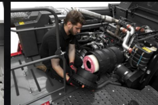
Überprüfen und Reinigen des Luftfilters
