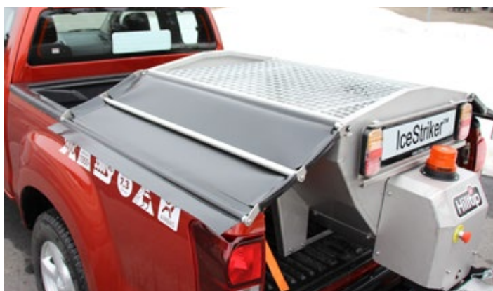
Le système de bâche et grille
