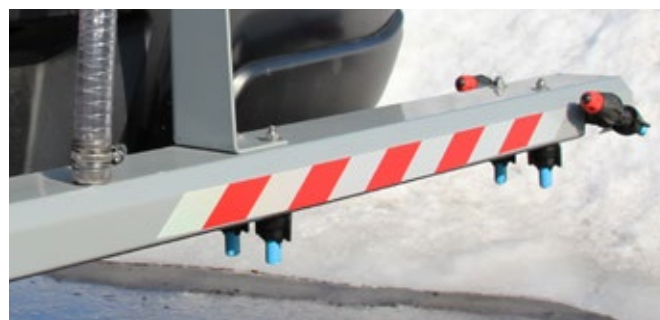
Double rangées de buses de pulvérisation pour un dégivrage homogène à haute vitesse.
