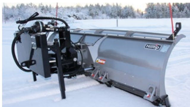
Dispositif de levage parallèle pour camions et machines avec plaque DIN.
