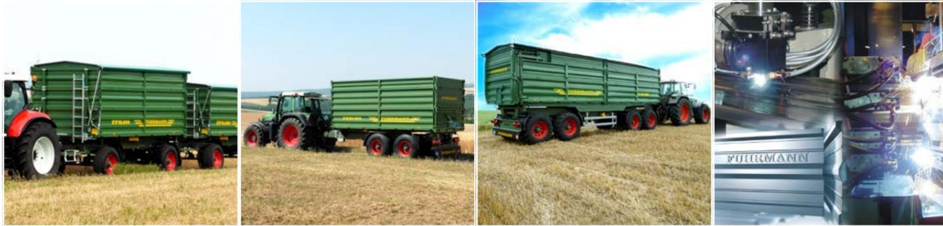
Durch diese Konstruktionsmerkmale bieten FUHRMANN-Kipper in Verbindung mit einer optimierten Fahrzeugrahmenweite, stabiler Blattfederung und breiter Fahrspur ausreichende Reserven im schweren Praxiseinsatz und hohe Standsicherheit im unebenen bzw. unbefestigten Gelände. Das zentrale Kipprohr mit den Kugelkipplagern leitet die Kraft optimal in den Hauptrahmen ein, Kippersteckbolzen mit der Überkreuzstecksicherung verhindern schwere Rahmenschäden durch falsches Einstecken der Bolzen.
