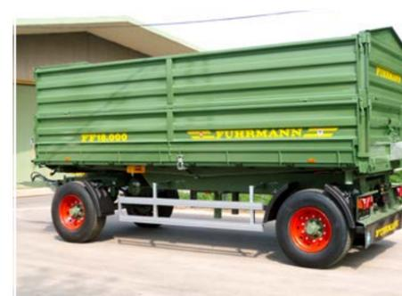
Plateauverlängerung für 2A- und TA-Kipper von 5150 auf 6000 mm
