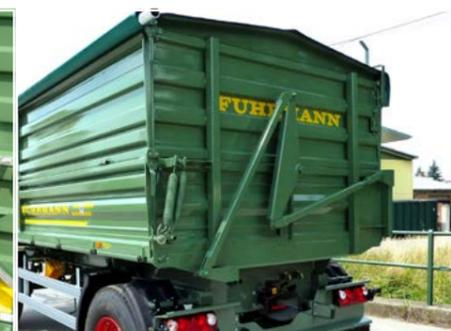
Automatische, mechanische Bordwandöffnung (90°) für 2-Seitenkipper
