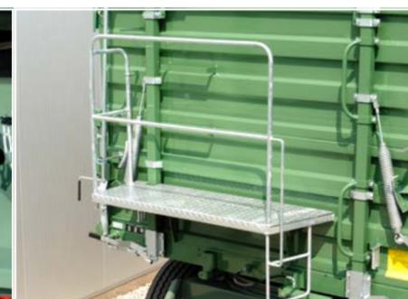
Bedienplattform an Stirnwall mit Sicherheitsgeländer
