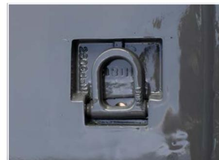
Zurrmulde im Boden versenkt, 2500 kg DIN EN 12640
