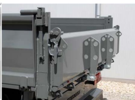
Hydraulische Rückwandklappe 400 mm hoch (geschlossen)
