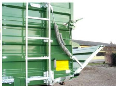
Bordwandhebefedernsystem für 800 mm Bordwände (teilabgeklappt)
