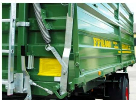
Bordwandhebefedernsystem für 800 mm Bordwände (Pendelbetrieb)
