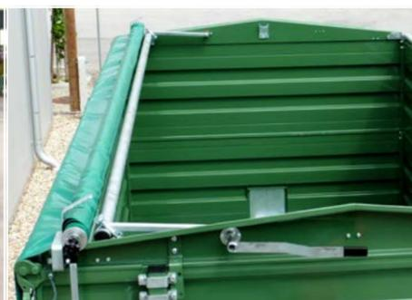
Klappbares Mittelrohr für Planenaufbau
