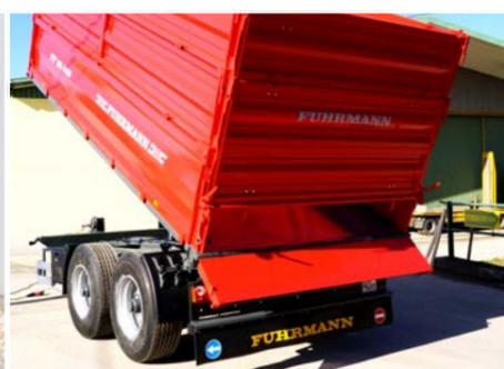
Hydraulische Rückwandklappe 400 mm hoch (geöffnet)
