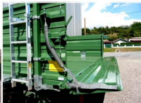
Komfort-Bordwandhebefedernsystem für 600 mm Bordwände (abgeklappt)
