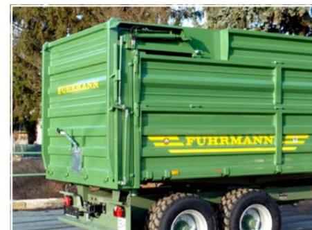
Hydraulische Rückwandöffnung mit zwei doppelwirkenden Zylindern
