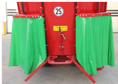
Austrag hinten, Futterablage hinter dem Rad
