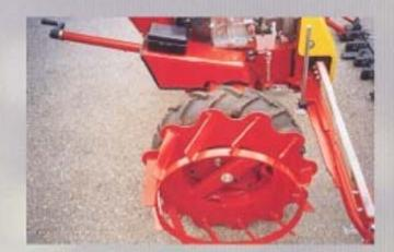
Stufenose Schwerpunktverstellung mechanisch mittels Kurbel, jederzeit während dem Fahren möglich. Dadurch immer richtiger Balkenauflagedruck.
