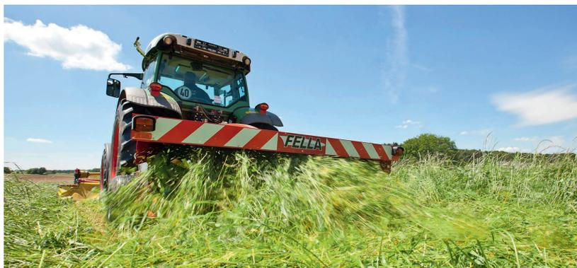
Durch den Heckanbau ist es möglich das Futter hinter den Traktorrädern breitflächig abzulegen.
