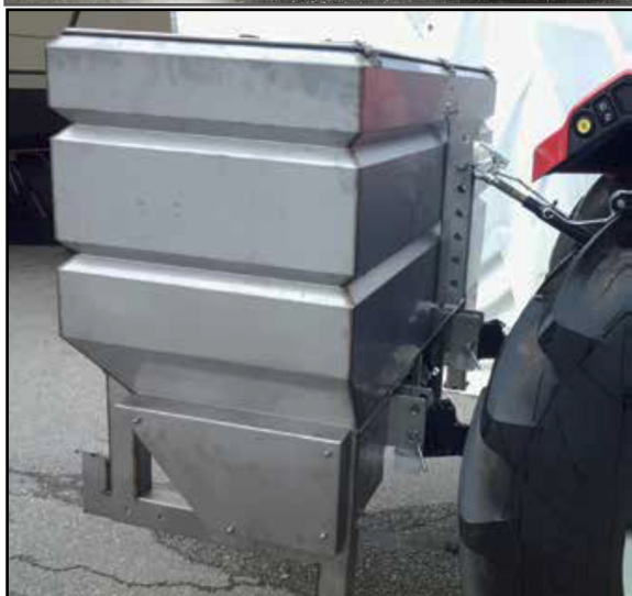
kompakter Anbau, Gewicht nahe beim Traktor
