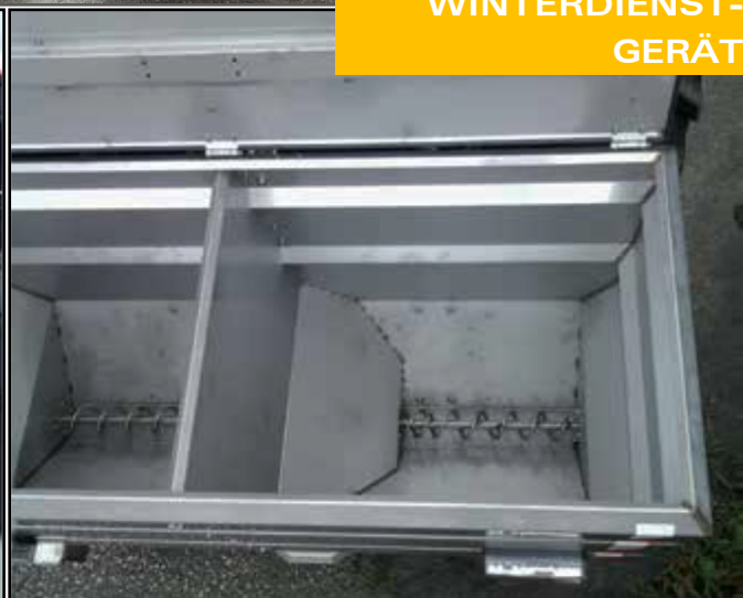
AKT 800/1100 INOX Spindelzuführung auch als Doppelkammerstreuer
