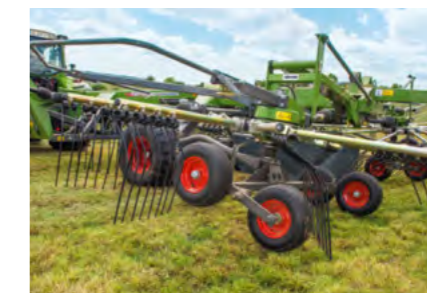
Am Vorgewende berühren beim Ablassen erst die hinteren Räder den Boden, danach die Bugräder. Beim Ausheben werden die Kreisel zuerst vorne ausgehoben. Dieser Jet-Effekt schont die Grasnarbe.
