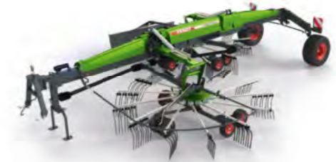
Seitenschwader mit Transportfahrwerk
