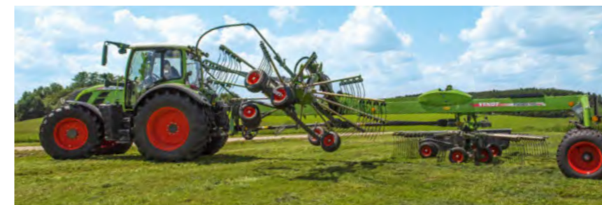
Die Folgesteuerung hebt die Kreisel der Fendt Former Schwader am Vorgewende perfekt nacheinander aus.
