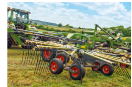
Am Vorgewende berühren beim Ablassen erst die hinteren Räder den Boden, danach die Bugräder. Beim Ausheben werden die Kreisel zuerst vorne ausgehoben. Dieser Jet-Effekt schont die Grasnarbe.
